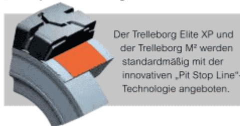
Die "Pit Stop Line" ist ein orangefarbener Indikator, der kurz vor Erreichen der Verschleißgrenze sichtbar wird. Damit signalisiert der Reifen, wann der nächste Wechsel geplant werden sollte.
