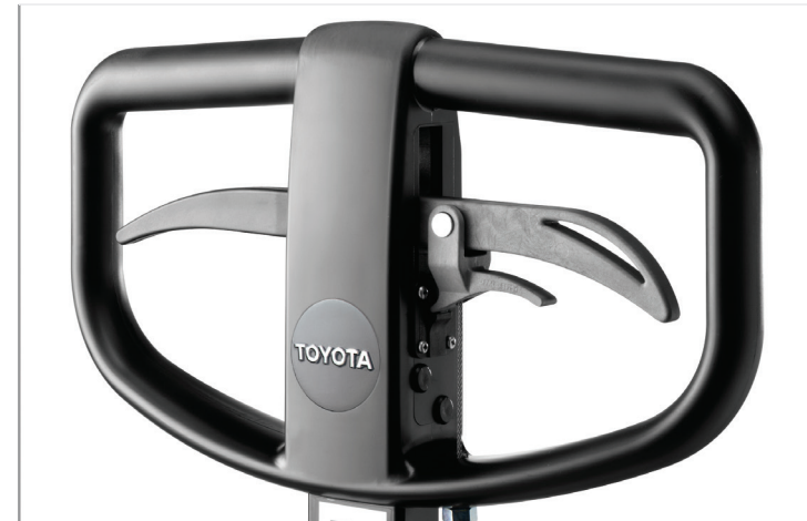
Aktivierung dieser Funktion per Hebel an der Deichsel.
