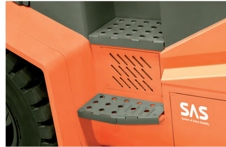
Die niedrigen, breiten Trittstufen und der große Haltegriff für den Auf- und Abstieg sorgen für mehr Sicherheit des Fahrers bei häufigem Ein- und Aussteigen.
