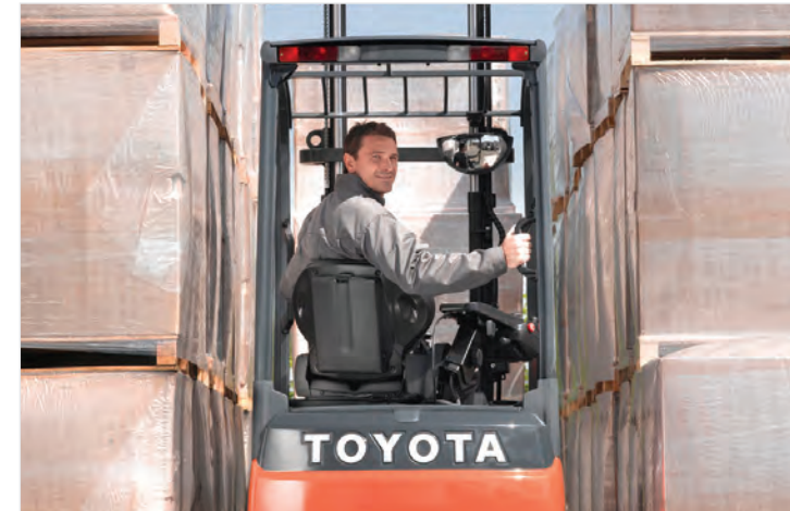
Hinterer Haltegriff verbessert den Komfort und die Produktivität beim Rückwärtsfahren, indem der Rücken des Fahrers entlastet wird. Optionaler Drehsitz erleichtert das Rückwärtsfahren und Ein- und Aussteigen.
