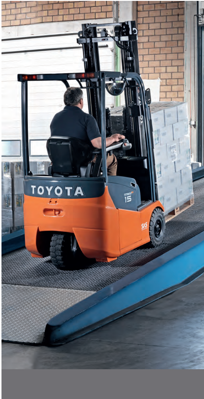
Das Freisicht-Hubgerüst bietet dem Fahrer ausgezeichnete Sicht auf die Last und das Arbeitsumfeld.
