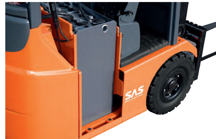
Serienmäßig niedriger Batterieaushub. Optional: integriertes Rollenbett für schnellen Batteriewechsel
