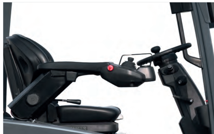
Minihel in der Armlehne ermöglichen die einfache Bedienung der Hebe-, Senk-, Neige- und Seitenschieberfunktionen mit den Fingerspitzen.
