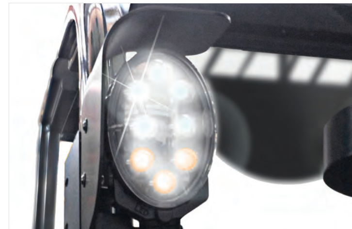
Leistungsstarke und energieeffiziente LED-Arbeitscheinwerfer verbessern die Sichtverhältnisse und ermöglichen das Arbeiten in der Dunkelheit oder in unbeleuchteten Bereichen
