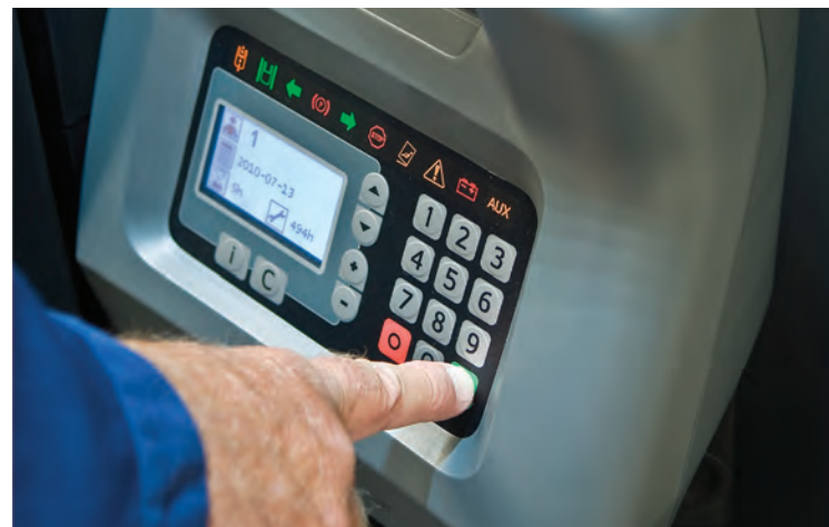
BT Access Control verhindert die Benutzung des Geräts durch nicht autorisierte Personen und lädt die persönlichen Voreinstellungen des jeweiligen Fahrers beim Start des Geräts.
