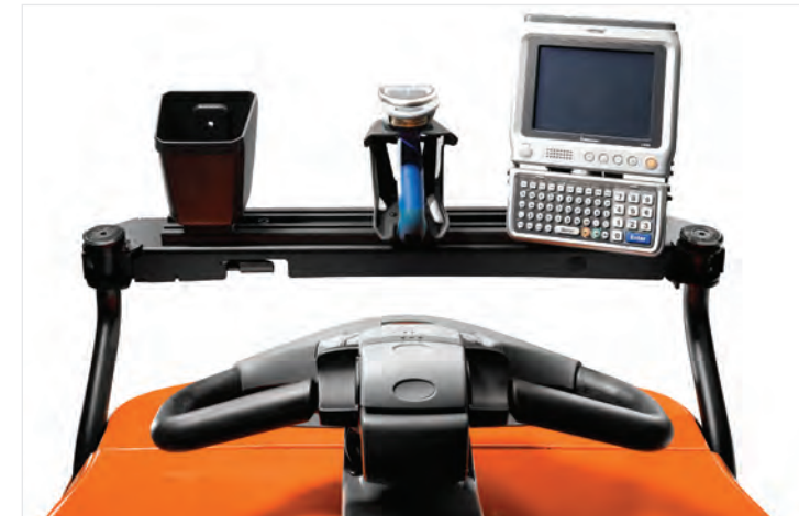
Optionaler E-Bar mit Stromversorgung für das einfache Anbringen von Zusatzausrüstung
