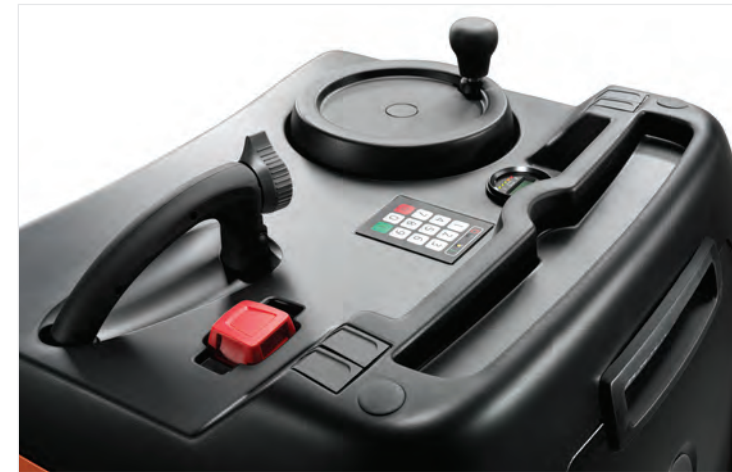
„Scheibenlenkung“ und PIN-Zugriffskontrolle
