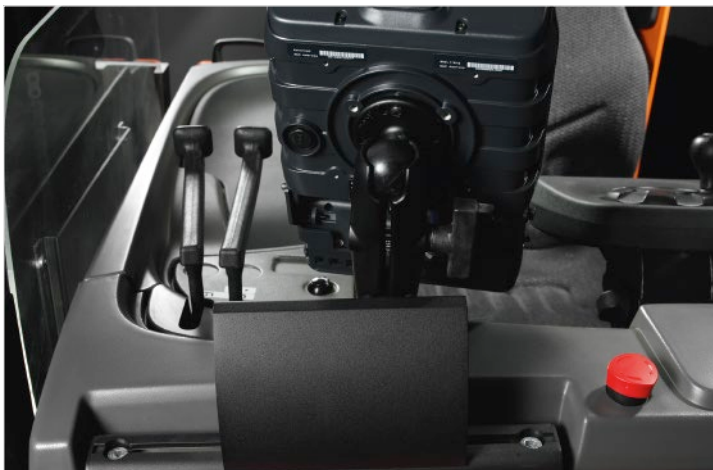
Über die E-Bar-Universalschiene lassen sich Zusatzgeräte, wie PC-Terminals, Barcode-Leser usw., leicht anbauen.
