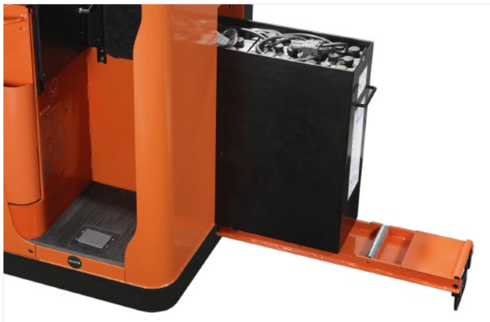
Dank Rollenbahn und integriertem Batterietisch lässt sich die Batterie bei der S-Serie leicht seitlich wechseln
