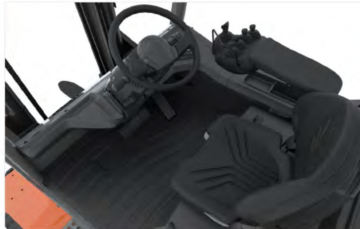
Geräumige, schwingend gelagerte Fahrerkabine; geräusch- und vibrationsarm und deshalb besonders bequem.
