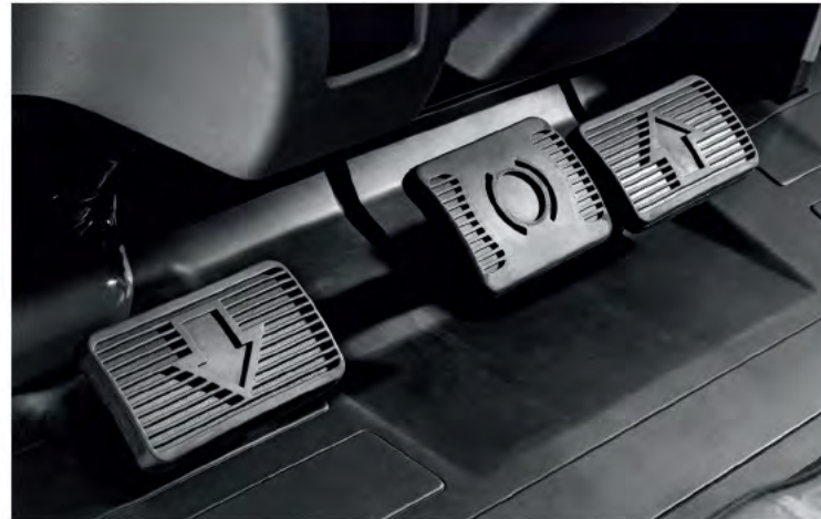
Unterschiedliche Pedalanordnungen je nach Fahrervorliebe. (im Bild: Doppelpedal-Anordnung)
