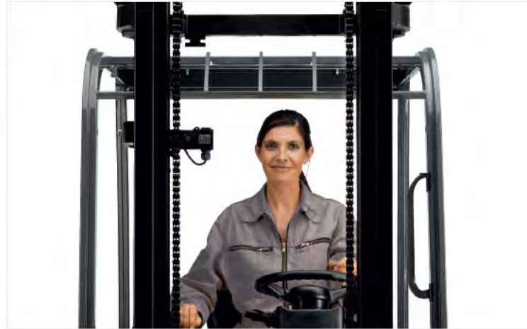
Das Freisicht-Hubgerüst bietet dem Fahrer ausgezeichnete Sicht auf die Last und das Arbeitsumfeld.
