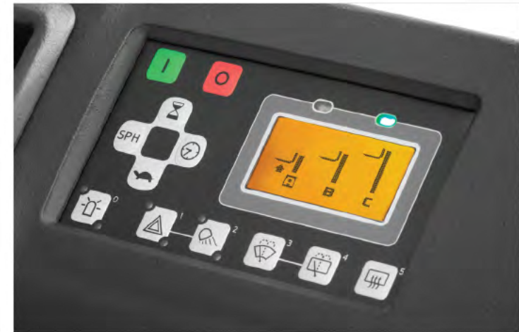
Mit der Hubhöhenvorwahl spart der Fahrer Zeit und Mühe.
