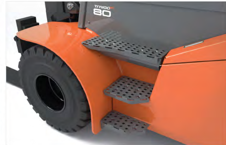
Der große Einstieg mit breiten Trittstufen und zwei Haltegriffen erleichtert das häufige Ein- und Aussteigen.
