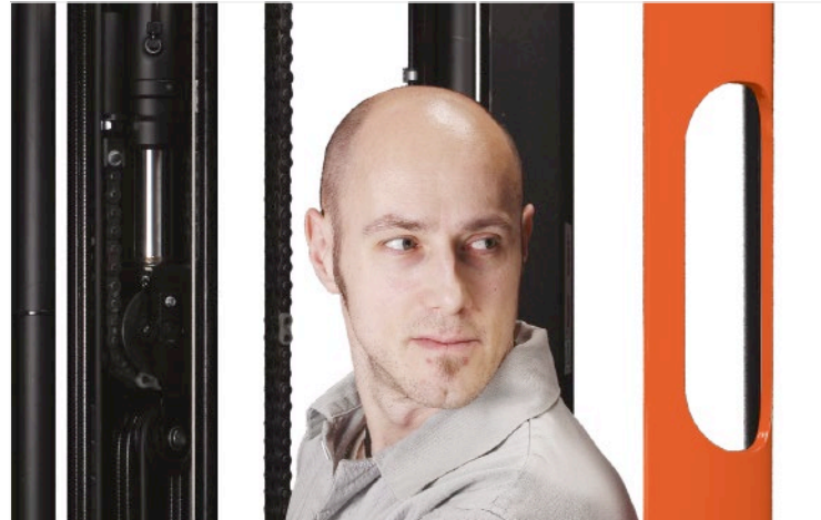
Bessere Sicht durch das Fenster in der hinteren Säule; so kann der Fahrer innerhalb der Gerätekontur bleiben und ist sicherer
