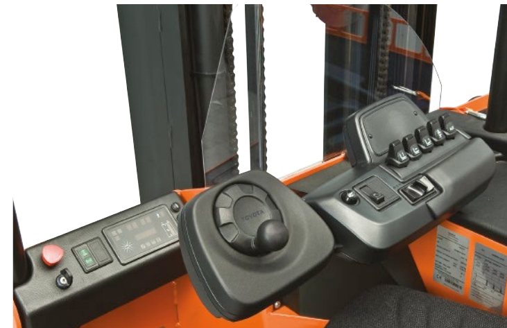
Fahrer sitzt in Gabelrichtung – für eine optimale Sicht auf lange und ungewöhnliche Lasten
