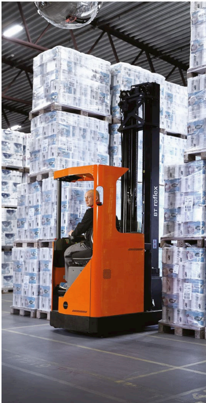
Bessere Sicht durch das Fenster in der hinteren Säule; so kann der Fahrer innerhalb der Gerätekontur bleiben und ist sicherer
