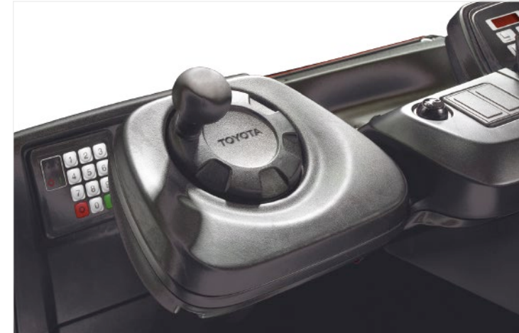
Die Modelle der BT Reflex N-Serie bieten eine intuitive, präzise 360°-Lenkung
