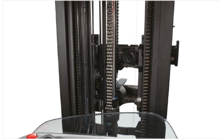
Der offene Gabelträger mit integriertem Seitenschub bietet eine perfekte Sicht nach vorne
