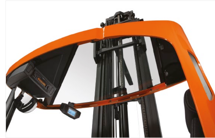
Das transparente Dach ermöglicht den freien Blick auf die Gabel beim Arbeiten in der Höhe.
