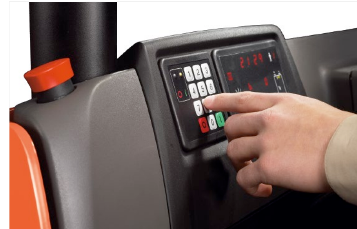
Das serienmäßige BT Access Control-System verhindert die Bedienung durch nicht autorisiertes Personal
