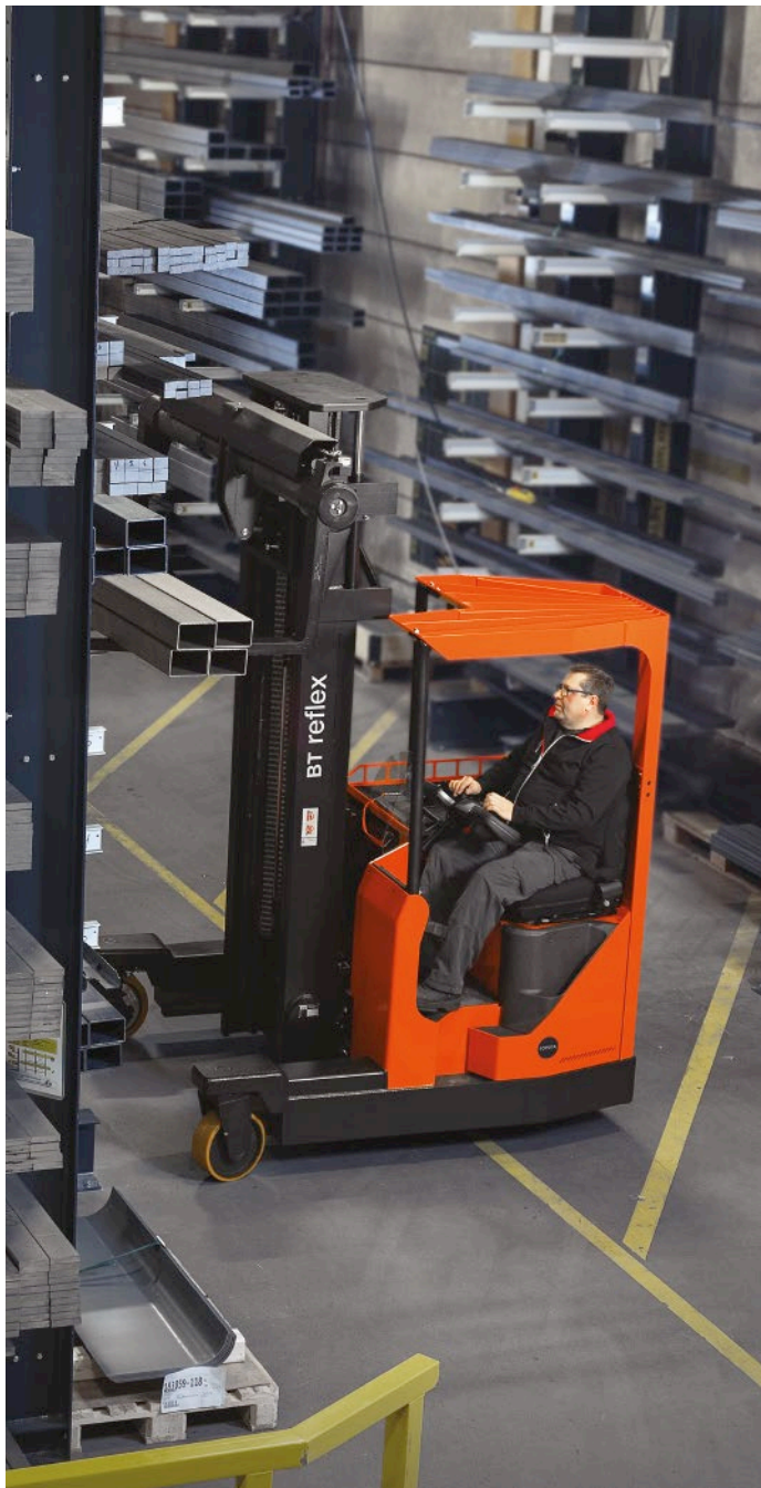
Schnelle Anpassung der Gabelbreite an unterschiedlich dimensionierte Lasten dank der hydraulischen Zinkenverstellung der BT Reflex F-Serie
